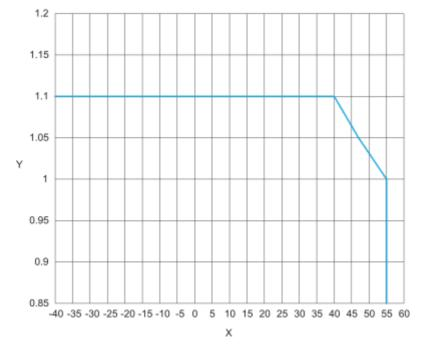
**X** : Operating temperature (°C) **Y** : AC coil voltage (UC)
